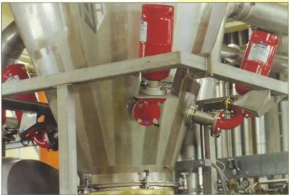
抑爆系统保护的喷雾干燥机
